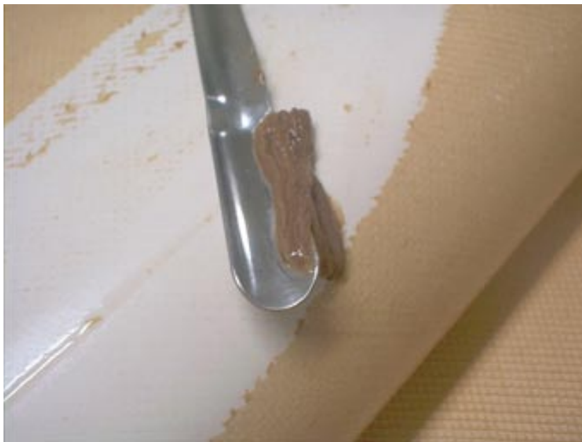
Figura 54. Depósito de materia coloidal en la superficie de una membrana. Foto cedida por cortesía de Genesys Membrane Products
