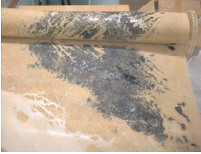
Figura 55. Depósitos de materia orgánica y biopelícula en la superficie de la membrana
